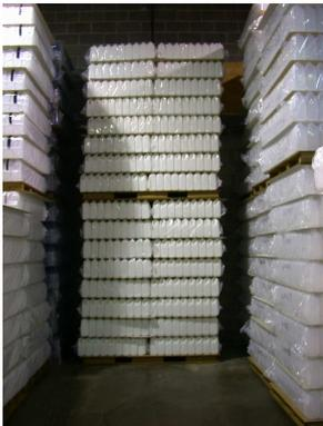
Las botellas de plástico vacías de poco peso empaquetadas en bolsas de plástico se apilan en 8 niveles por palé. 2 de los palés usan Grip Pad para el almacenamiento interno.
