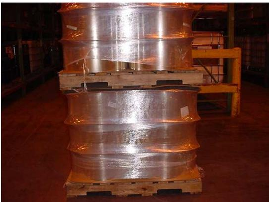
Los rollos pesados se transportan en palés apilados de dos en dos usando un Grip Pad entre los dos palés
